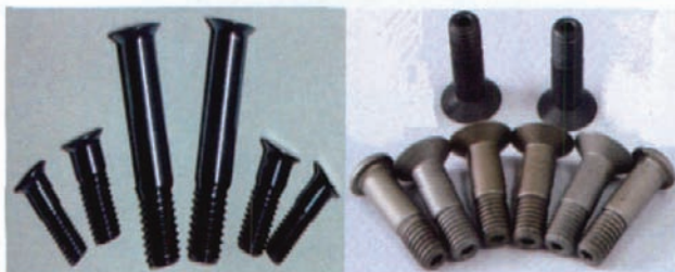
(a) 蓝色阳极化的普通高锁螺栓 (b) 涂层处理的轻型高锁螺栓
